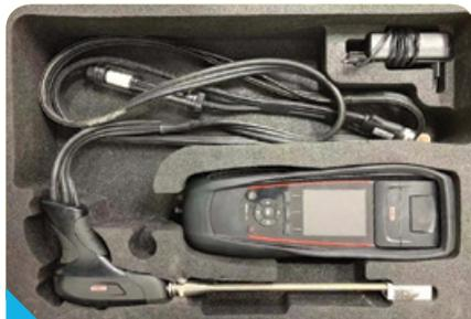
便攜式煙氣分析儀應用：為確保燃氣鍋爐排放符合要求，購買便攜式煙氣分析儀自行對各排放站點進行煙氣監測，超標時及時處理，減少排放。
